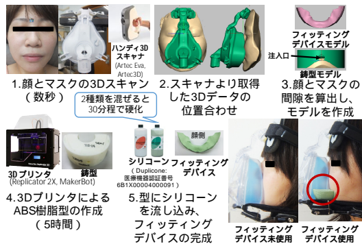
図2. NPPV フェイスマスク圧迫創傷予防のためのパーソナライズドフィッティングデバイス作成過程
