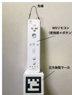
図3：入力デバイスのプロトタイプ
