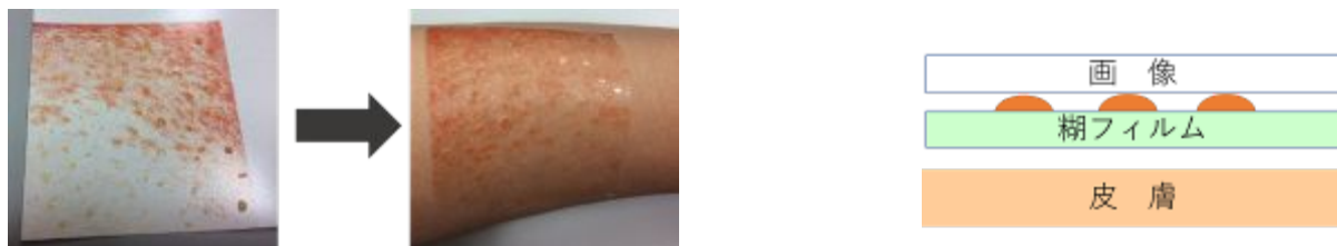
図5( ) シールの画像と糊フィルムの間層にラテックス(液体ゴム)によるエンボス(浮き出し)加工を行った。2mm以下の丘疹などは作成できたが、3mm以上のものはシールが破損するため作成できなかった。
