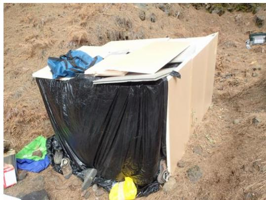
図4：亀裂/断層の露頭近辺に設置された簡易暗室の写真。30分程度で完璧な遮光が施された。
