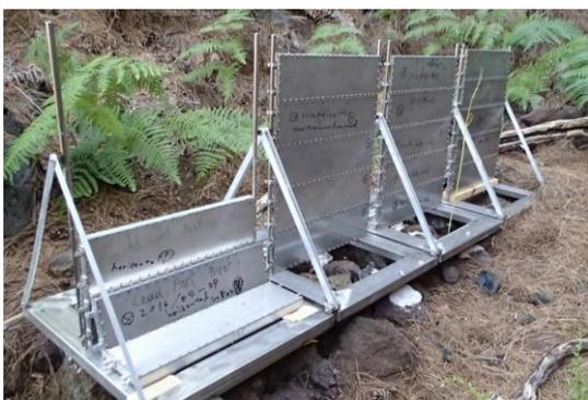
図5：露頭近辺に設置されたミュオン検出器。手前右から奥左に向かって、亀裂/断層を通ったミュオンが通過する。
