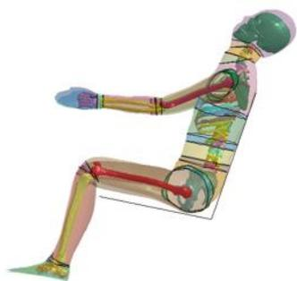
図7 乗員モデルによる後面衝突解析
