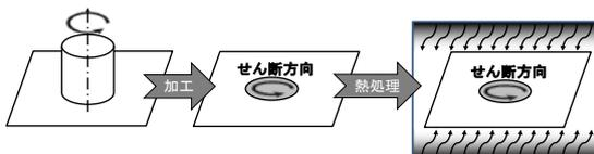
図 1 バニシング加工のプロセス
