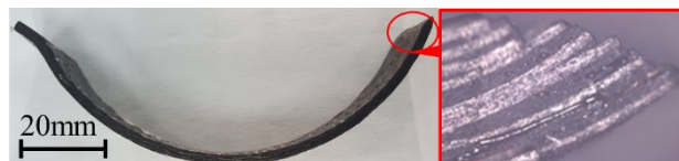
図6．連続繊維 CFRP 曲げ試験結果
