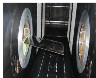
図 4 後退角のある翼模型
