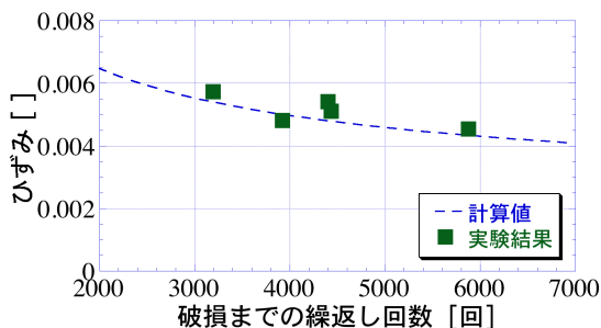
図 8 ひずみと破損までの繰返し回数
