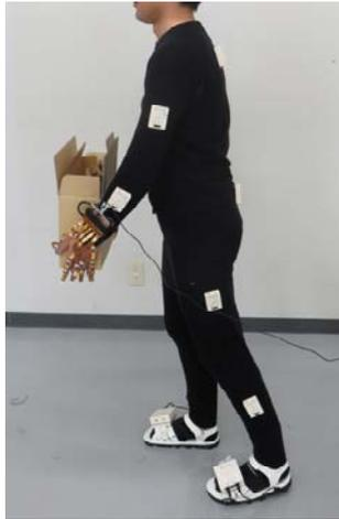
図 6 ウエアラブルな全身運動計測システム
