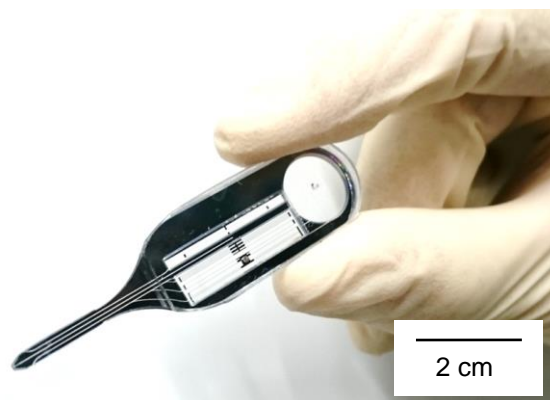
図 4 作製したピペット型ロボチップ。
