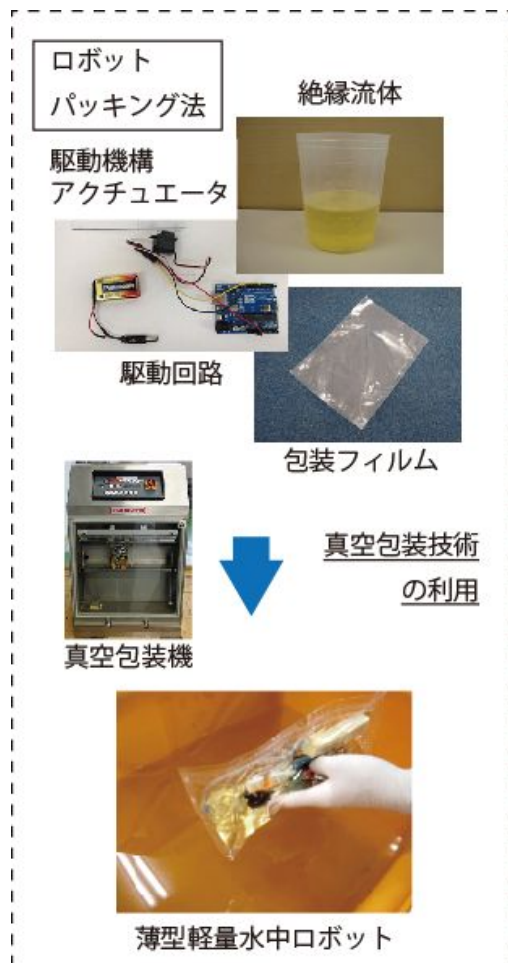
図1: ロボットパッキング法による魚型水中ロボットの製作
