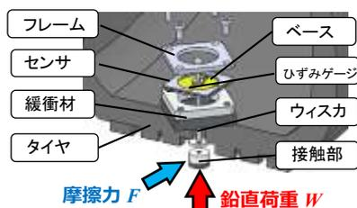
図 1 センサ構造
