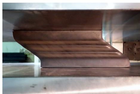
写真-2 実験の様子 (引張 2MPa, せん断ひずみ 250% 荷重時)
