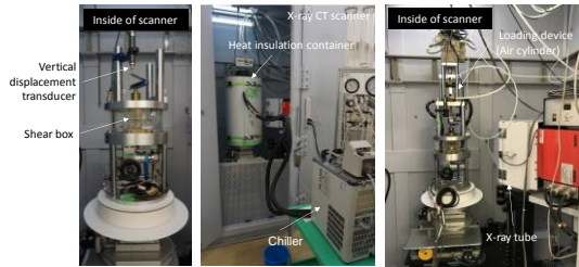
図3 凍結融解地盤の一面せん断試験
