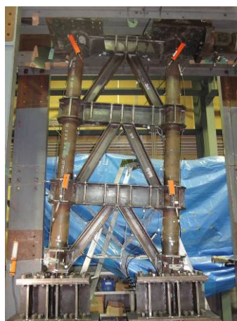
図 3 PC 鋼棒緊結試験体の载荷風景
