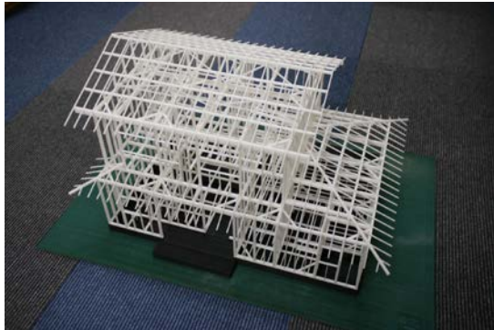
図 6：在来木造住宅の三次元モデルとその検証のための三次元プリンタ出力
