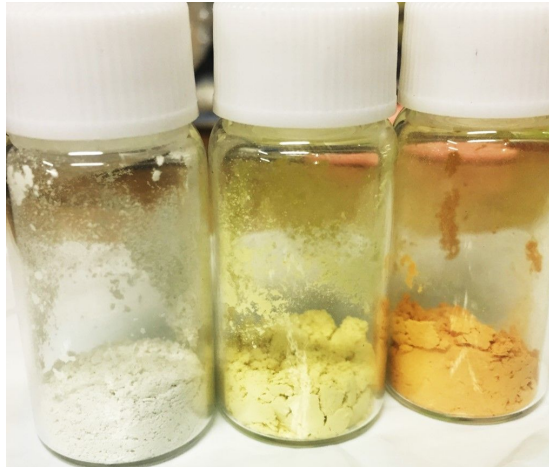
図2 (Fe, Nb)共添加 TiO 2 の一例 左から、rutile 型 TiO 2 (出発原料)、 Ti 0.990 Nb 0.005 Fe 0.005 O 2 、 Ti 0.980 Nb 0.010 Fe 0.010 O 2
