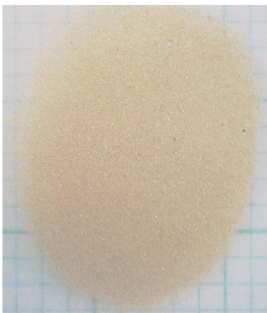
図 1 フラックス法で合成した Cu 添加 α-PbO 2 型 TiO 2 背景の方眼は 1 mm×1 mm
