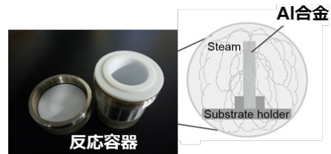
図 3 水蒸気プロセスに使用した反応容器の外観写真および容器内の模式図
