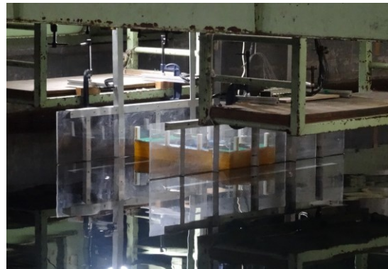
図2 2次元浮体を用いた水槽実験の様子。浮体の両端部のアクリル板は、波浪場の 2 次元性を確保するための整流板。
