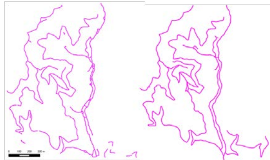
図-1 出力結果 (左：自動抽出 右：実際の線形)
