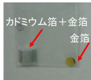
図 1 . 放射化検出器 (左 : 金箔、右 : カドミウム箔で覆った金箔) の設置
