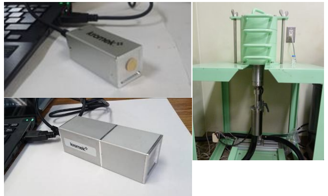
図 2 . 測定に用いた各放射線検出器 (左上 : CdZnTe 半導体検出器、左下 : CsI シンチレーション検出器、右 : HP-Ge 半導体検出器)
