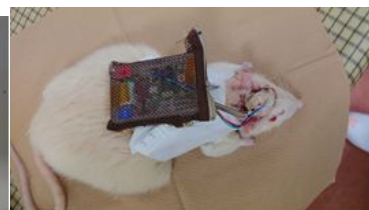
図 7 . 電池を小型化した改良 型慢性通電システムをでサイ ンを変更したラットジャケッ トによりラットに装着
