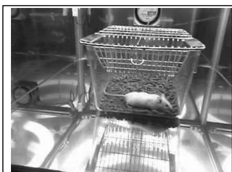
図 光照射ケージ 全面金属反射材張り。空調設備有。
