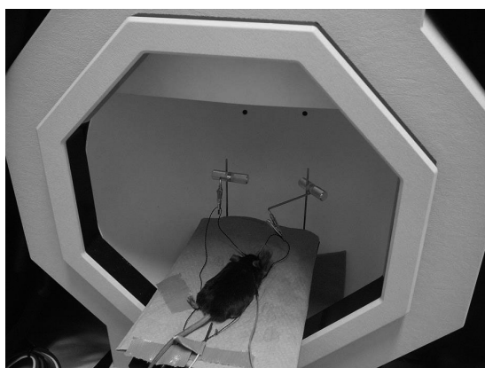
図 網膜電図(ERG)測定装置。
