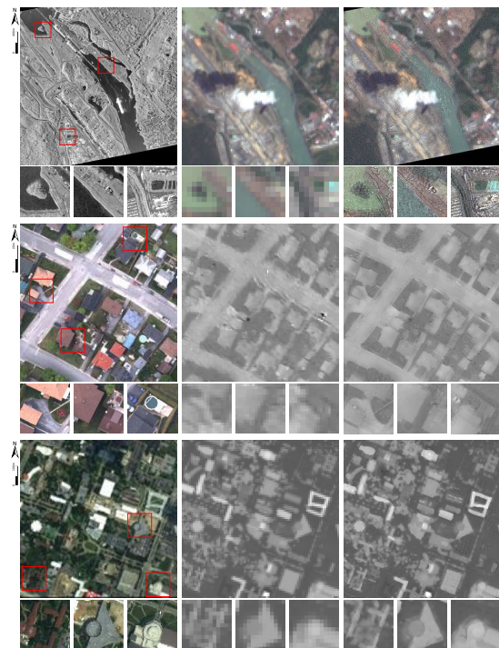
図4. マルチモーダル画像融合による高解像度化. 左から右は高解像度画像, 低解像度画像, 高解像度化画像. レーダと光学 (上), 可視光と熱赤外 (中), 光学と標高モデル (下) の融合。
