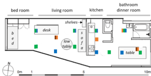
図2: 実験の場所を上から見たものと加速度センサー設置位置。赤：2個、オレンジ：4個、青：7個、緑：8個。
