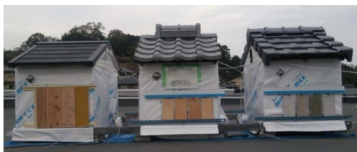
図9 屋外暴露試験体 (左から杉板、素焼き板、花崗岩)
