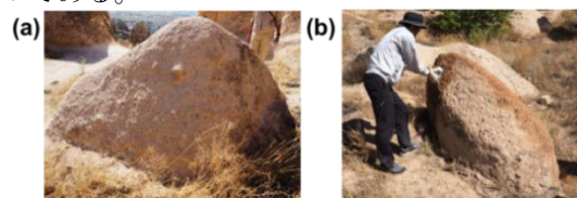
図13 屋外暴露試験体 (a) 無処置 (b) 撥水处理あり
