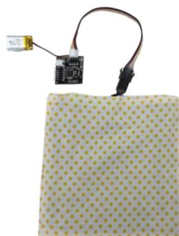
図 2 開発した布だけで構成されるタッチパネル
