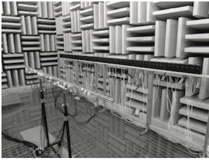
図 2 : 実装した 64 チャンネルスピーカアレイ
