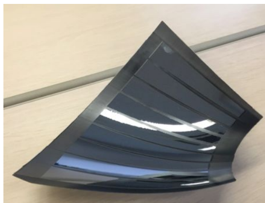
図3：CFRPを用いたシリコン結晶（半径200mm）
