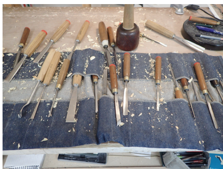
西洋で使用される木材加工の道具 (使用される道具の違いから、標本に用いられる技法、構造の違いへと推察を広げることが出来る。)
