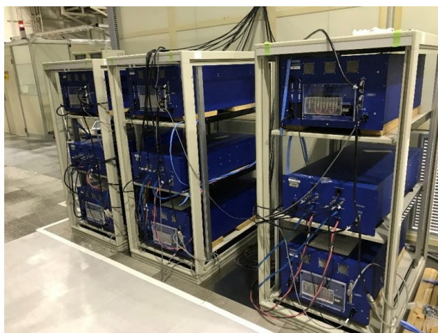
図3 バーストレザー用フラッシュランプ電源の外観
