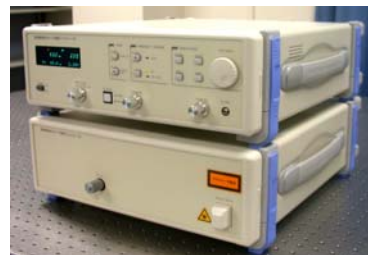
図 1 40 GHz モード同期ファイバレーザの構成とその外観
