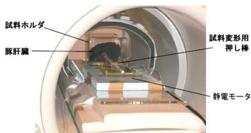
図4 静電モータによるMRI内部での生体試料変形装置
