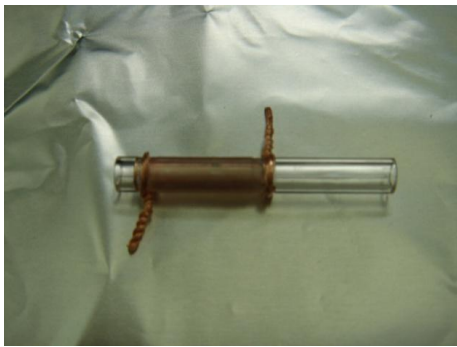
図 29. 完成したマイクロコイル
