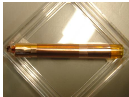
図 23. シード層を形成したパイプ
