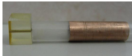
図 39. 完成した 1mm 径マイクロコイルと 5mm 径マイクロコイル
