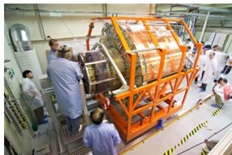
図1 2006年2月CERNにて日本グループの設計製作による組み立て装置を用い、TRT検出器内にSCT検出器を組み込むことに成功
