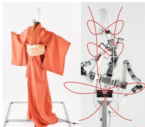
着物外装 上半身機構と有機的な動きの軌跡
