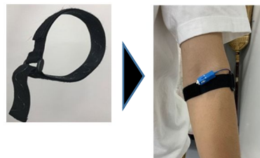
図6 FBG センサ導入繊維製品
