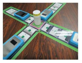
ータ利用:中等高等教育用) )を開発した(写真参照)。KIND-mini ではワンタッチでの線量・計数率の表示のみを標準とし、比較的若年層をユーザーに想定して、取り扱いの簡便さを最優先するために放射線計測器としての機能を最小限に抑えている。一方 KIND-Pro では感度の向上を図ると共に積分時間の変更や信号の出力を可能にするなど、多岐にわたるユーザーの使用形態、教育目的に応えるための多くの追加的な機能を標準実装している。教育現場に ICTを導入する流れは世界各国でも早い時期に広がっていくはずで、ここで開発した次世代型線量率計はその一助になると確信している。
