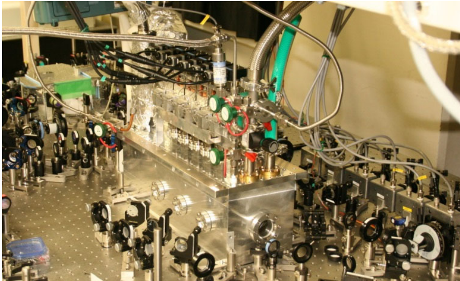
図2. 開発した、液体窒素温度下で任意位相制御可能なラマンセル。
