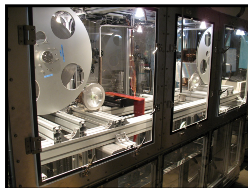
図1. リール式走査型ホール素子磁気顕微鏡システム
