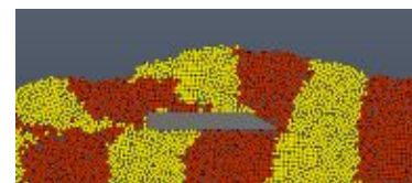
(b) 提案経路：(a)より土の圧縮や盛り上がりが小さい
