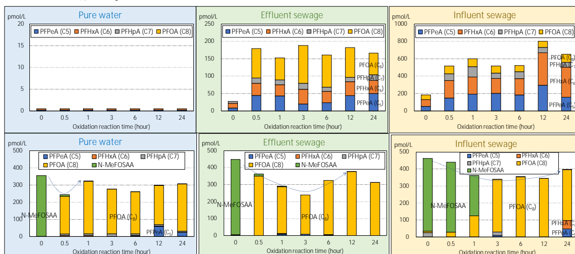
図2 純水(左列)、下水処理水(中列) および流入下水(右列)を試験媒体として、前駆体 N-MeFOSAA を無添加系(上段)と添加系(下段)における前駆体と生成物質濃度の分解時間による変化(TOC: 純水 = 0 mg/L、下水処理水 = 6.8 mg/L、流入下水 = 32.0 mg/L) (PFPeA = perfluoropentanoic acid; PFHxA = perfluorohexanoic acid; PFHpA = perfluoroheptanoic acid; PFOA = perfluorooctanoic acid)
