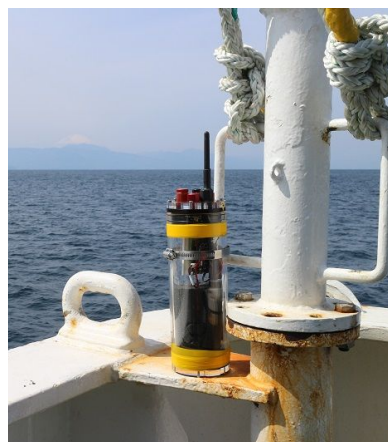
図3 GPS位置発信装置と船尾に取り付けた様子。アンテナを除いた容器のサイズは260x90mmだが、電子回路の基板サイズは約70x45mmである。
