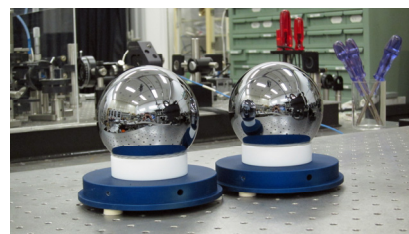
図2 ^{28}\text{Si} 単結晶球体
