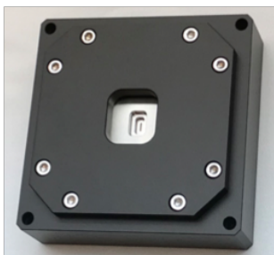
図 3 上段: 完成した観測装置。観測ロケットの筒 (擬似的に半透明化) におさまられている。 図 3 下段左: スリット鏡とスリットホルダー。光学面とは逆の面から写した写真。迷光対策のため、ホルダーには黒色化を施した。 図 3 下段中: 280nm 用偏光板。インストールのためのテフロン枠をはめているところ。 図 3 下段右: 拡大光学系内の軸外し双曲面鏡。スーパーインバー製のホルダに接着。
