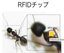
図 1:測定対象のアリの背に貼付した一辺 0.5mm の微小 RFID チップ (拡大図内の四角形)
