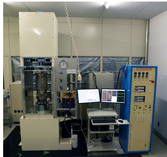
図1. 海洋研究開発機構・高知コア研究所で開発、そして設置された回転式熱水剪断試験機の全景。水圧120MPa、温度450、垂直応力60MPaの条件で、スロー地震～巨大地震のすべり速度に匹敵する10nm/s～1m/sでのすべり運動を再現できるスペックを有する。写真左部分の透明アクリル板の後ろにあるのが認可を受けた第一種圧力容器。
