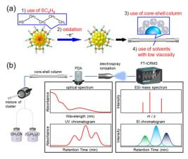
図3. (a)高分解能分離を実現するための4つの工夫、(b)本研究で用いた装置
