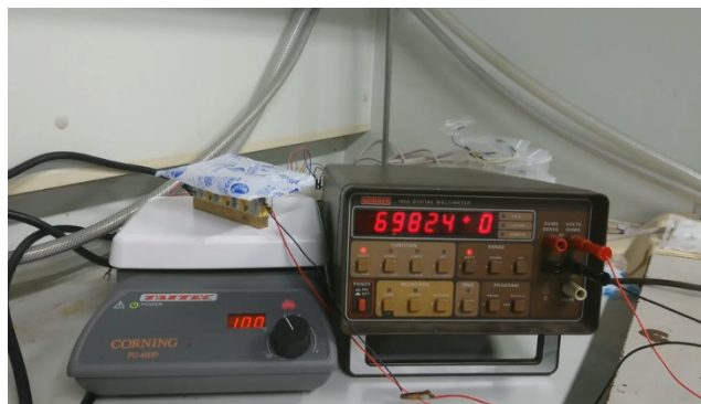
図 9 モジュール動作の様子(電圧計の値:698.24 mV)
